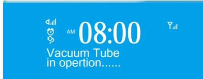
echoStream Viの電源を入れると、ディスプレイは常に「時計」で始まり、図のように真空管のウォームアップが自動的に開始されます。20秒間のウォームアップ後に、echoStream Viをお楽しみいただけます。
