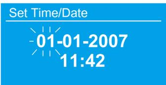
「更新なし」を設定すると、ウィザードは時刻と日付を手動で設定するようになります。日付と時刻は、YYYY-MM-DDおよびhh : mm AM / PMとして表示され、最初の値はdd（日付）、点滅する箇所が変更できます。「選択」コントロールで各値を調整します。各値が設定されると、次の値が変更箇所となり、点滅します。.(左方小圖示要改成YYYY-MM-DD)
